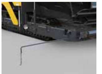
走行指針照明灯
