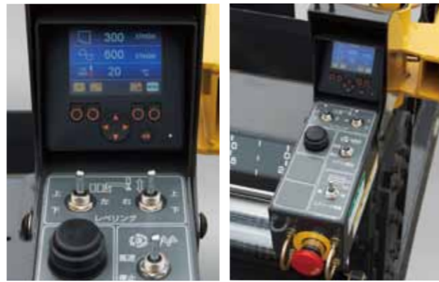
スクリーン操作ボックスのカラーサブモニター
